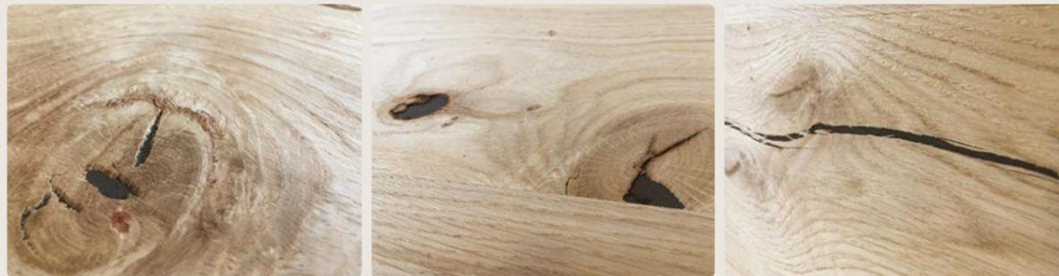
Die Detailabbildungen zeigen die typischen Merkmale des FACHWERK Furniers. Von Astlöchern und Rissen bis hin zu deutlich sichtbaren Farbunterschieden innerhalb einer Fläche reicht die natürliche Anmutung der Echtholz-Oberfläche.
